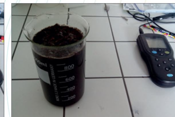
Obr. 21c. Výluh z rašelinné půdy. Vpravo konduktometr.
