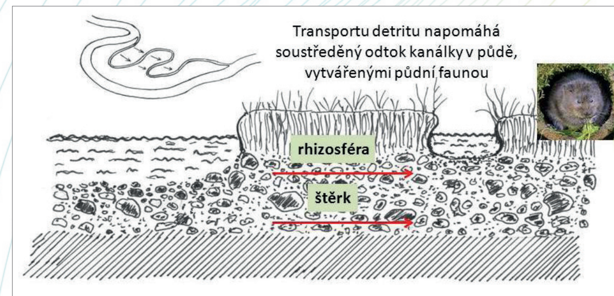
Obr. 177. Podpovrchový průtok vody šterkovou vrstvou mezi meandry ORP nebo stružek v přirozené šterkovité nivě. Produkty opadu jsou vnášeny přímo do intersticiálních prostor v hyporeálu (zvodněného prostředí pode dnem toku) orig. J. Hruška.
