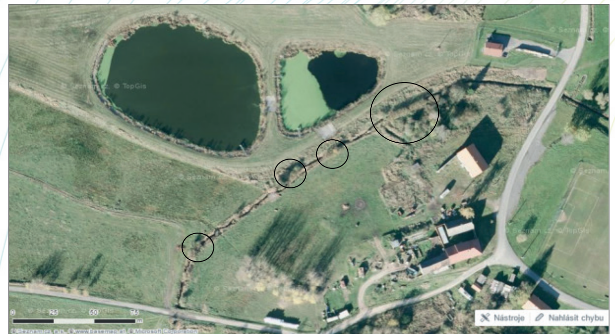
Obr. 201. Pohled na současný stav obrostlých válců (velký snímek, haťošterkové válce v černých kroužcích) a stav napřimeného koryta před revitalizací (na vloženém snímku z roku 2004). Zdroj: Mapy.cz, © Seznam.cz, a.s., © TopGis, s.r.o.).
