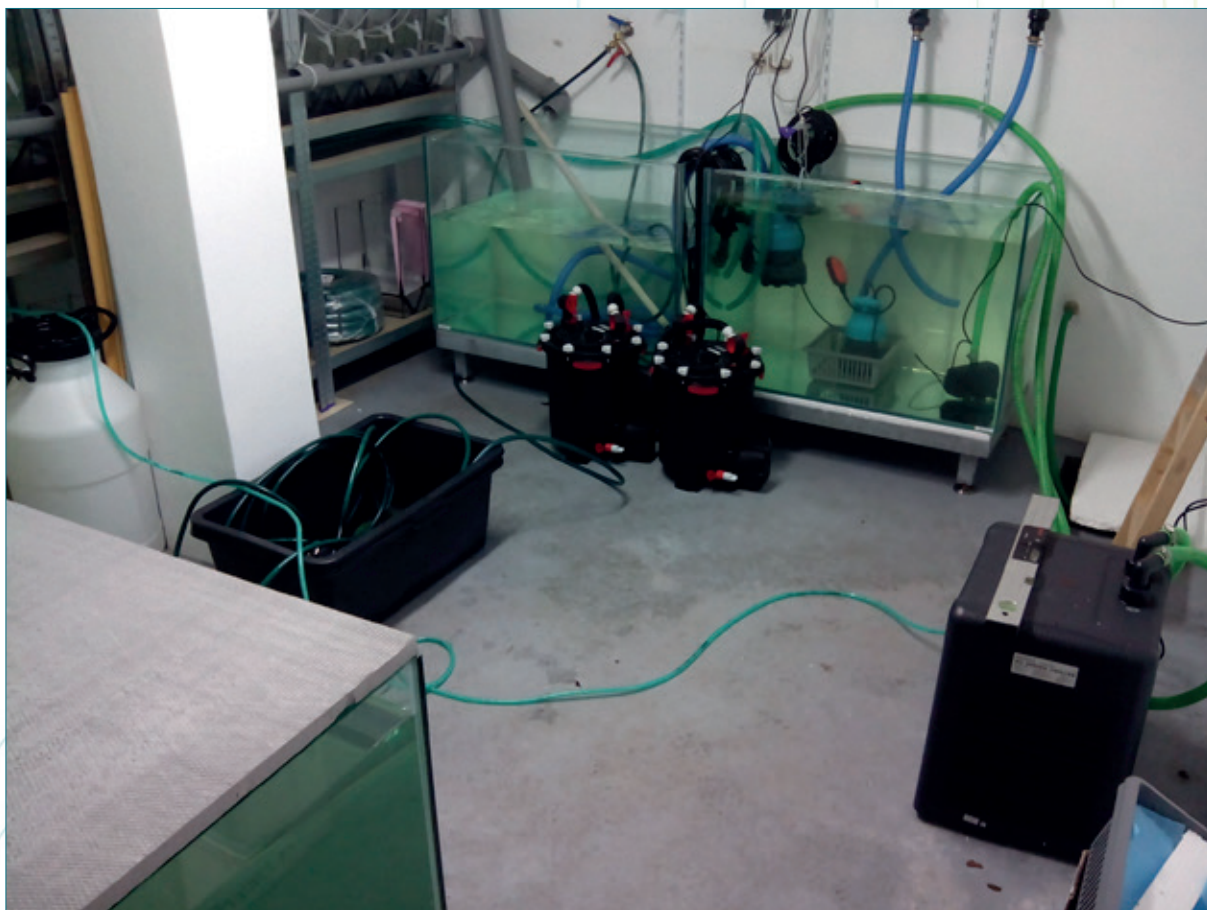
Obr. 35a. Odchovné zařízení pro ryby. Recirkulační odchovný systém sestavený K. Doudou v rámci řešení projektu OPŽP „Soužití člověka a perlorodky ve Vltavském luhu“, využívaný Správou NP Šumava k odchovu perlorodek.
