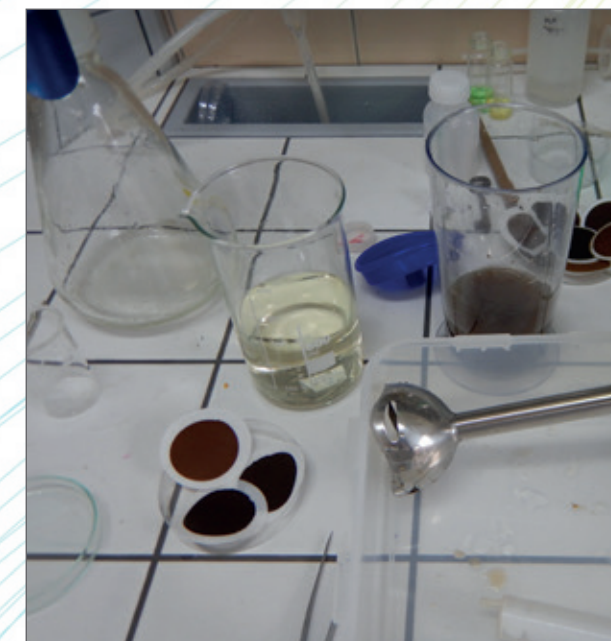
Obr. 21a. Příprava umělých analogů detritu v laboratoři. Zcela vlevo filtrační zařízení, v kádince přírodní voda na ředění, dole GF/C filtry s pevnou frakcí po filtraci homogenizátu, mixérová nádoba a nerezový tyčový mixér.
