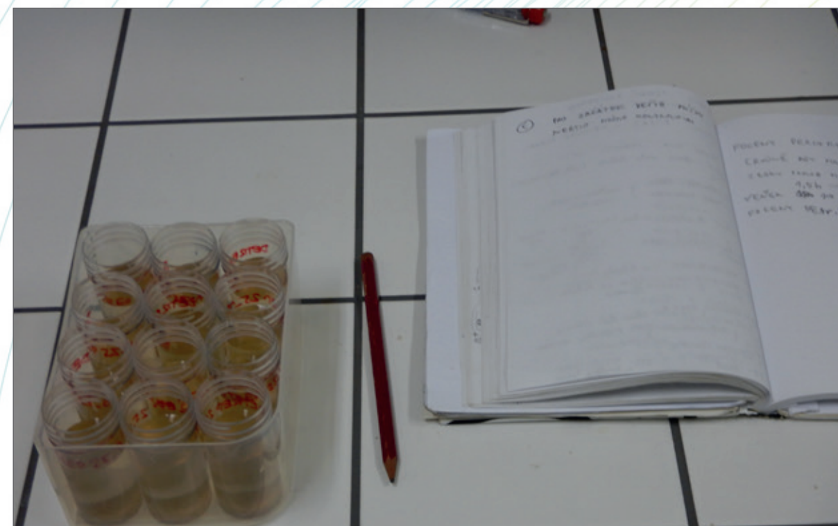
Obr. 65b. Mikrometoda v epruvetách (individuální chovy) s menšími prostorovými nároky i menší potřebou množství detritu ve vzorku.
