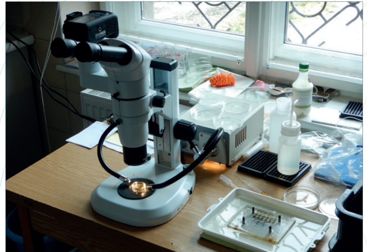
Obr. 52a. Trinokulární lupa s fotoaparátem pro fotografování juvenilních perlorodek.
