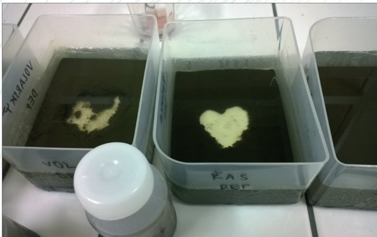
Obr. 66c. Detrit pro bioindikace je nutné uchovávat při nízké teplotě a vzorky opatrně pipetovat ode dna.
