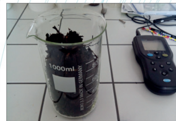
Obr. 21b. Příprava výluhu z rašelinné půdy. Vpravo konduktometr.
