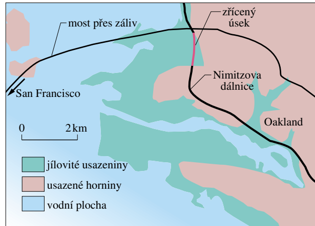
Obr. 16.21 Geologická struktura části Oaklandu v okolí zálivu San Francisco s vyznačením zříceného úseku Nimitzovy dálnice. (Převzato z článku „Sediment-Induced Amplification and the Collapse of the Nimitz Freeway“ autorů S. E. Hougha a ostatních, uveřejněného v časopise Nature 26. dubna 1990).
