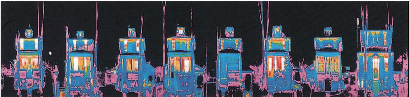
Obr. 19.19 Barevný termogram prozrazuje výkon, s jakým se vyzařuje energie z domů na ulici. Výkony jsou vyznačeny barvami, od nejvyššího k nejnižšímu: bílá, červená, fialová, modrá, černá. Můžeme rovnou říci, kde jsou stěny izolované, kde jsou na oknech těžké záclony a kde je teplejší vzduch u stropu v poschodí.
