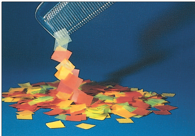
Obr. 22.1 Statická přilnavost — elektrický jev zvláště výrazný v suchých dnech — způsobuje, že se kousky papíru slepí dohromady a přilepí se k plastikovému hřebenu, že se vám šaty lepí na tělo atd.
