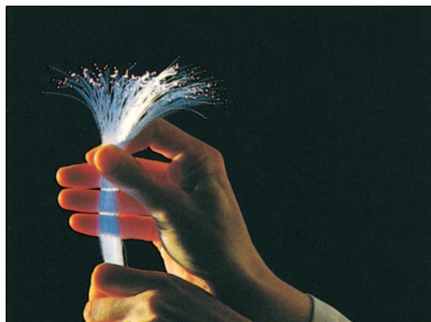
Obr. 34.25 Světlo, které vstoupilo do jednoho konce optického vlákna, prochází na jeho druhý konec s malými ztrátami na stěnách vlákna, protože většina světla se na těchto stěnách opakovaně úplně odráží.
