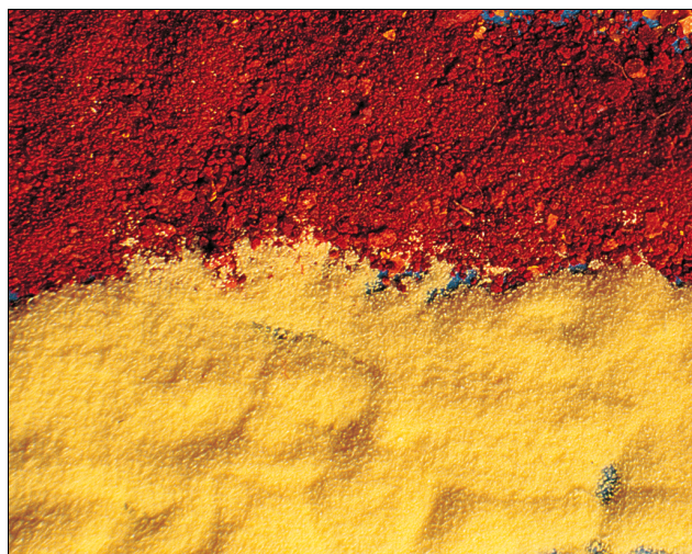
Obr. 40.8 Dva vzorky práškového polovodiče selenidu kademnatého se liší pouze velikostí zrn. Každé zrno se chová jako potenciálová jáma, ve které je vázán elektron. Horní vzorek má zrna větší, takže povolené hladiny energie jsou sobě blíže a prahová energie fotonu, který může být vázaným elektronem absorbován, je menší. Nepohlcené světlo je odraženo, takže se horní vzorek jeví jako červený. Spodní vzorek má zrna menší, povolené hladiny jsou od sebe dál a prahová energie absorbovaného fotonu je vyšší; vzorek se proto jeví jako žlutý.
