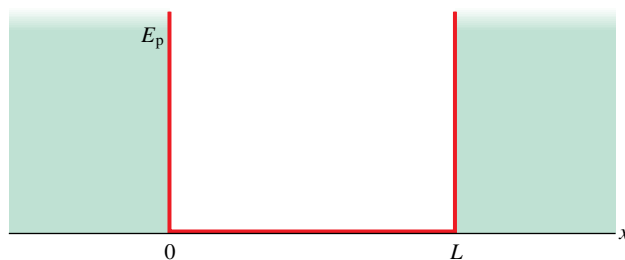
Obr. 40.2 Elektrická potenciální energie E_p(x) elektronu, který je „uvězněný“ ve středním válci ideální pasti z obr. 40.1. Vidíme, že E_p = 0 pro 0 < x < L a E_p \rightarrow \infty pro x < 0 a x > L .
